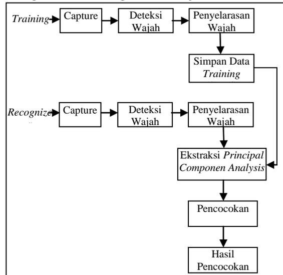
Gambar 4.2 Diagram Blok Pengenalan Wajah
